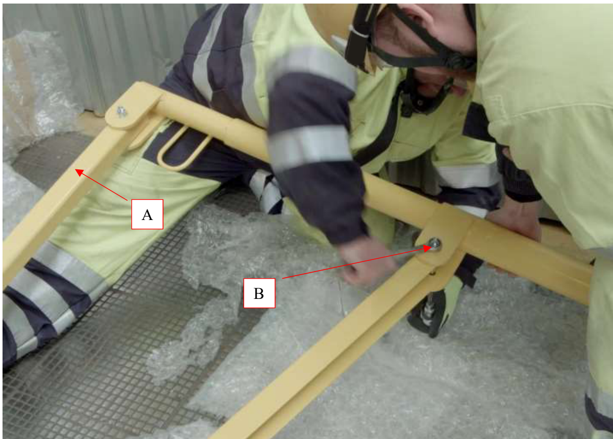
Kolejność montażu przy składaniu ramienia obrotowego RJ200.06.000-B
